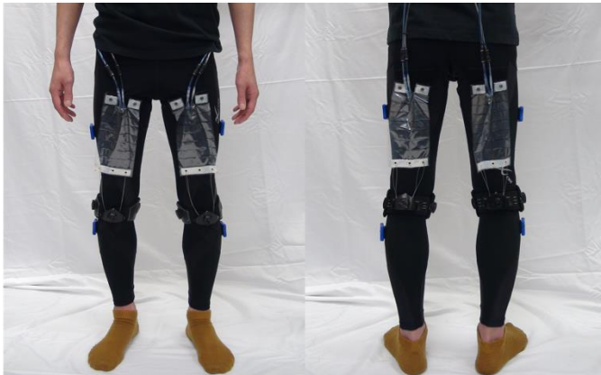
日常生活での脚動作(起立・歩行)支援を目指したインナー型アシストクロージング
